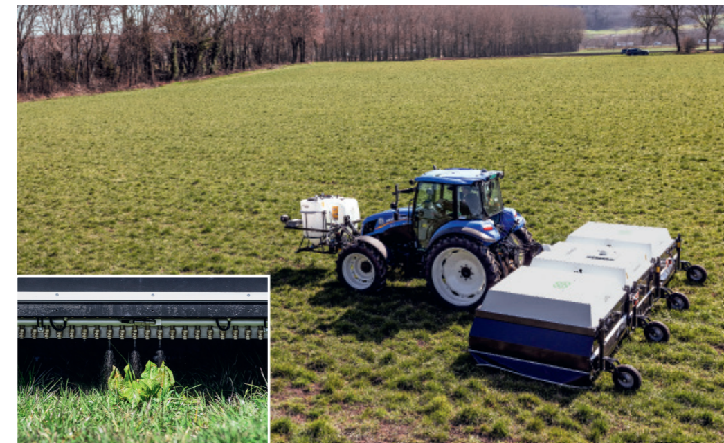
Le pulvérisateur ARA ne pulvérise pas d'herbicides à grande échelle comme le ferait un agriculteur sur son tracteur, mais plutôt avec une pipette. Photo: ecoRobotix
