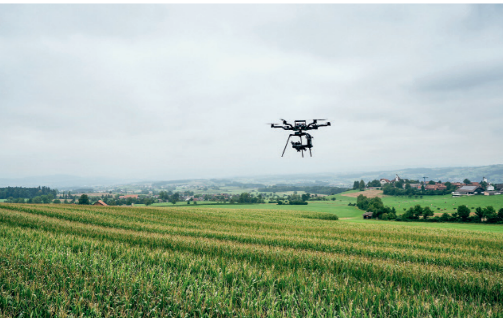
Des drones équipés de capteurs survolent déjà les champs pour mesurer par exemple la végétation des plantes. Cela permet d'évaluer la quantité de biomasse, et du même coup de calculer la teneur en azote. Photo: Swisscom
